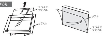
パネル側面からスライドファイルの端を持って、上から引き出します。(パネルをタテに使用時には右側) スライドファイルの間にソフトをはさみます。
