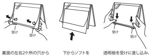
裏面の左右2ヶ所の穴から指を差し込み、透明板を受けからはさみず。
