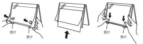
裏面の左右2ヶ所の穴から指を差し込み、透明板を受けからはずします。
