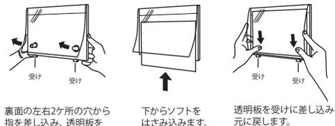
裏面の左右2ヶ所の穴から指を差し込み、透明板を受けからはさみず。
