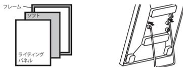
裏面からライティングパネルをはずして、ソフトの入れ替えをして下さい。 器具本体裏面の穴に、スタンドを差し込みます。
