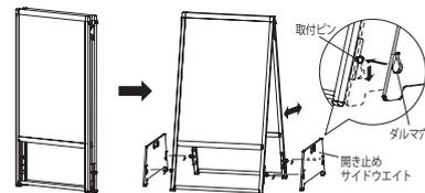
スタンドの脚を開いて立たせ、開き止めサイドウエイトのダルマ穴を取付ピンに引掛けて取り付けます。
