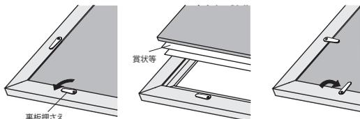
裏板押さえを回転させて中身を取り出します。 賞状などをセットしフレームに戻します。 裏板押さえを回転し、裏板を固定します。
