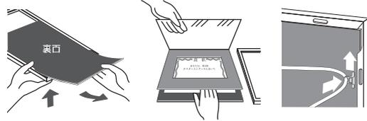
中身を表側から押し、斜めにスライドさせて取り出します。 賞状をマットの下に入れて、フレームに戻し入れます。 吊りを穴に差し込み、上にスライドして固定します。
