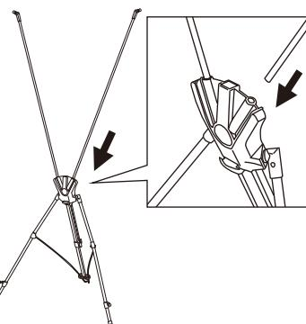
本体フレームの上部にある穴に上部バーを上図のように差し込みます。
