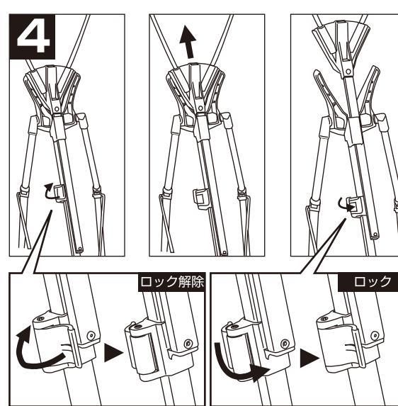
本体フレーム背面のロックを外し、バナーに適度なテンションがかかるまで、フレームの高さを調節し、再びロックします。(バナーの張り過ぎにご注意下さい)
