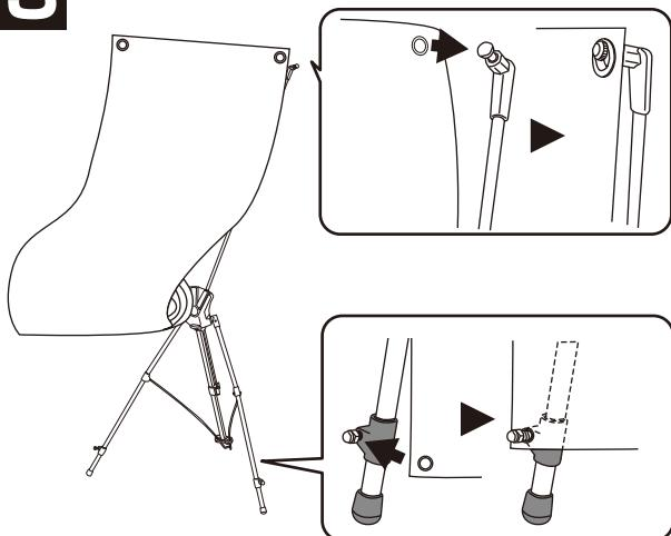
上部バー先端のネジと、本体フレーム下部にあるネジにバナーを取付けします。
